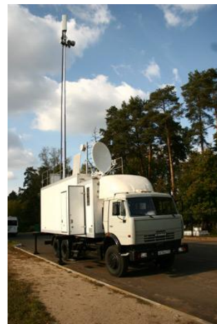
Рис. 3. Мобильная базовая станция
