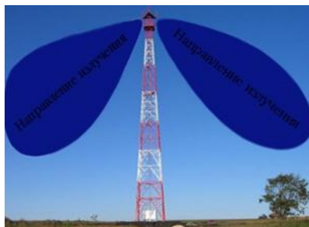
Рис. 3. Примеры формы и направления электромагнитного излучения БС: а) трехмерная модель электромагнитного излучения БС; б) опасное для здоровья населения направление антенно-передающего устройства
