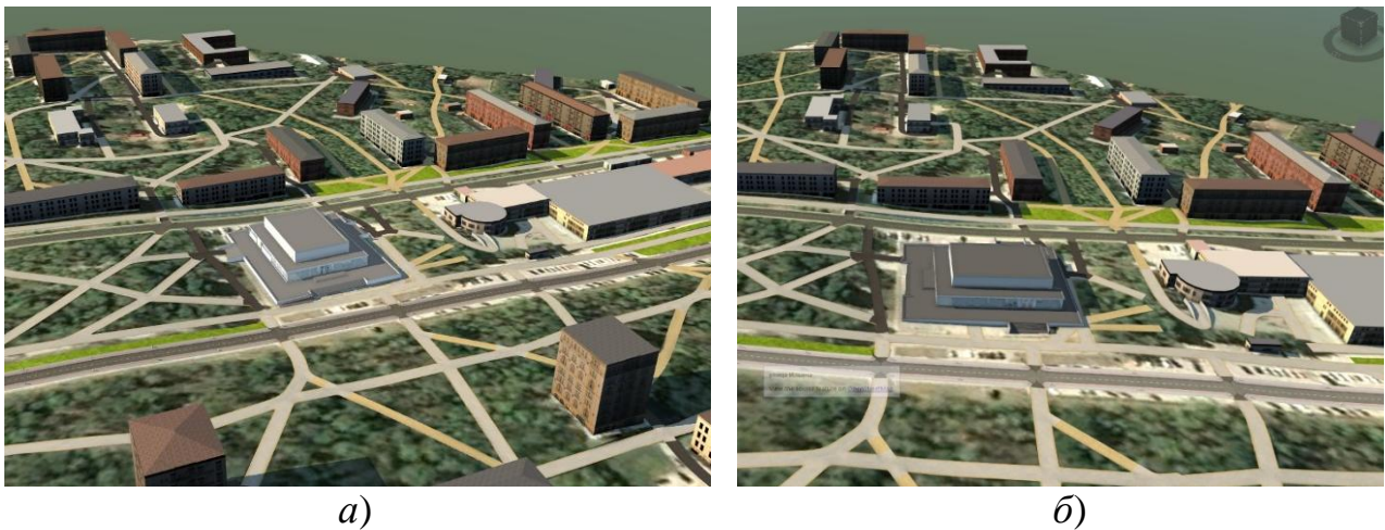
Рис. 2. Трехмерная модель дома культуры Академия: а) Северо-Восточное ориентирование лицевого фасада здания (реальное положение объекта); б) Юго-Восточное ориентирование лицевого фасада здания (модельное положение здания, при котором обеспечивается оптимальная освещенность помещений)
