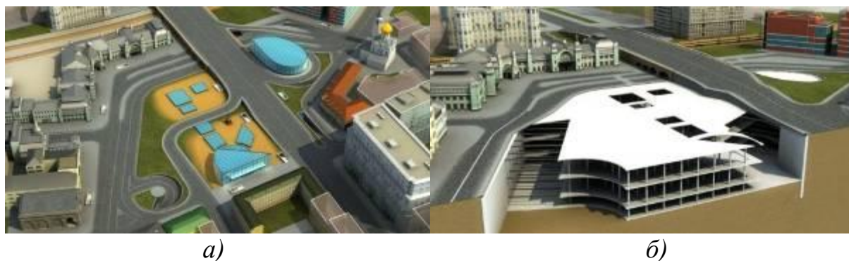
Рис. 1. 3D-модели кадастра при регистрации: а) вид участка на поверхности; б) вид участка в разрезе
