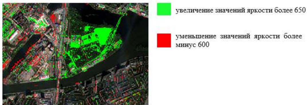
Рис. 4. Результаты выявления изменений между датами 18.09.2015 и 28.08.2019 методом, основанным на использовании индексных изображений
