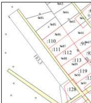
Рис.3 – Протяженность тупикового проезда превышает допустимые нормы
