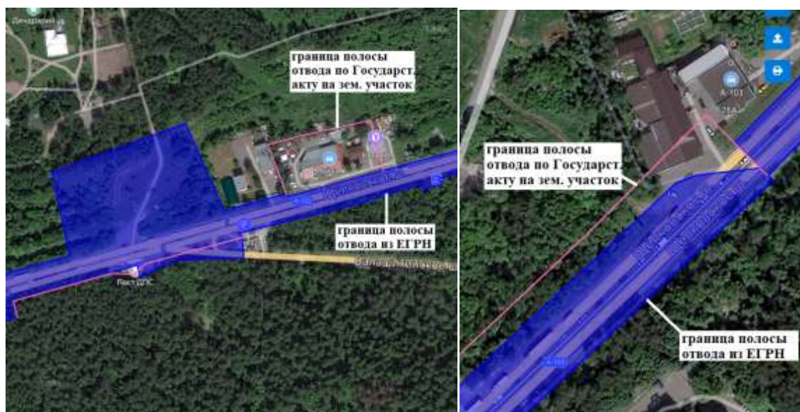
Рис. 1 – Нарушение границ полосы отвода автомобильной дороги А-103
