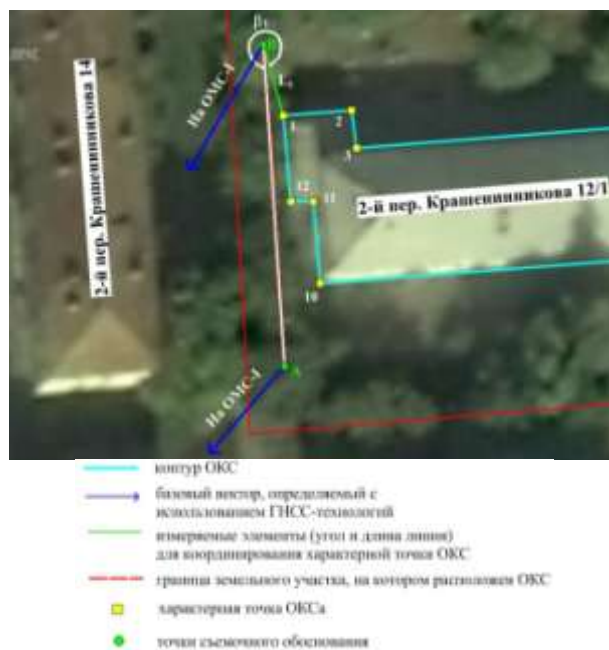
Рис. 2. Принцип координирования характерных точек ОКСа с использованием комбинированной ГНСС-технологии
