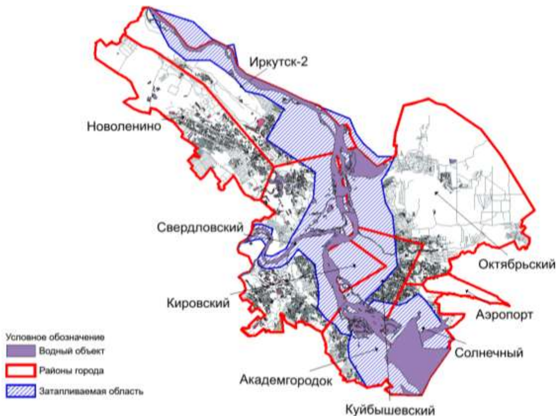
Рисунок 1 – Территория, затапливаемая в случае прорыва плотины ГЭС
